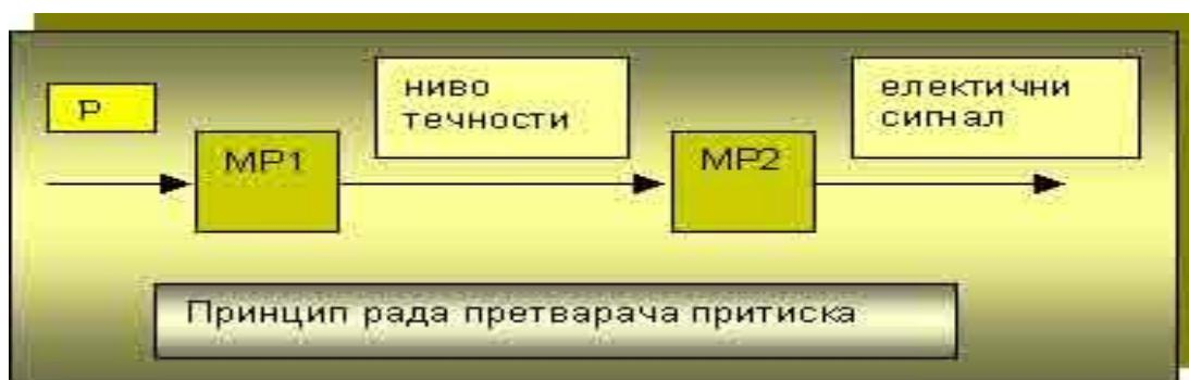
Kod elastičnih pretvarača se koristi efekat elastičnih deformacija tankih metalnih elemenata ugrađenih u njih. Pod pritiskom fluida ciji se pritisak meri dolazi do pomeraja koji se dalje pretvara u električni signal. Takav signal se može lakše obrađivati, meriti...
